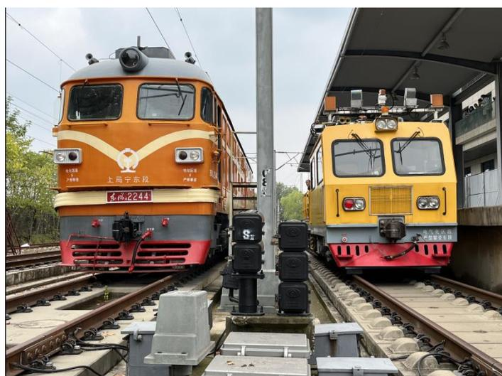
校园 DF4 内燃机车和接触网轨道车
